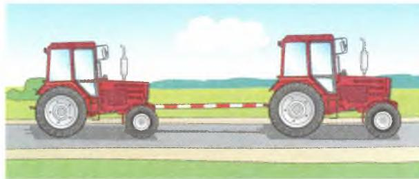
1. Неисправна рабочая тормозная система.
