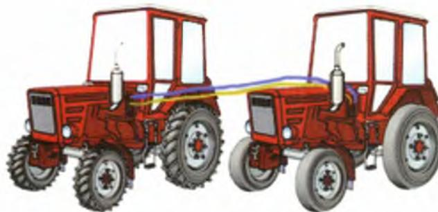
1. При монтаже в первую очередь соединяется отрицательный (-) кабель, а при демонтаже отсоединяется положительный (+) кабель.
