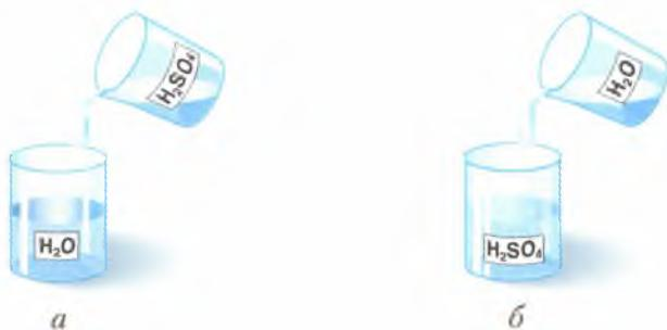
1. Залить в тару дистиллированную воду, затем в нее добавить кислоту (а).
