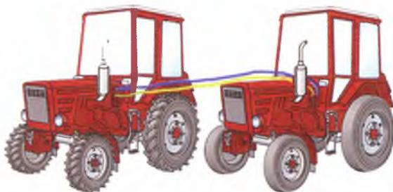
1. При монтаже в первую очередь соединяется отрицательный (-) кабель, а при демонтаже отсоединяется положительный (+) кабель.
